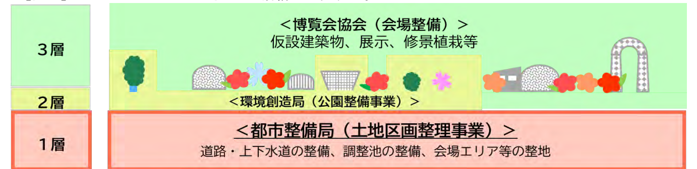
【図 2】GREEN×EXPO 2027 に向けて 3 層構造で行う工事のイメージ
